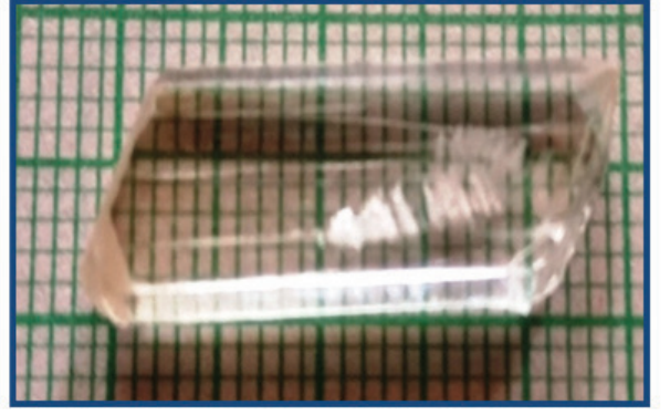
படம்.2 மெதுவாக ஆவியாதல் தொழில் நுட்பம் (SEST) மூலம் வளர்க்கப்பட்ட 2APD படிக்கம்
