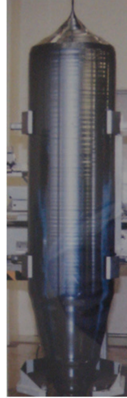
படம்-4: செக்ரால்ஸ்கி முறையில் வளர்க்கப்பட்ட மிக பெரிய சிலிக்கான் படிக்கங்கள்.
